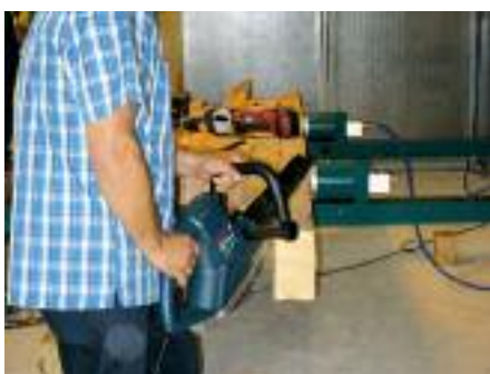
Abb. 1: Schifterschnitte mit Hilfe des elektrischen Fuchsschwanzes (Alligator)
